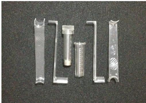
图 1 精准旋切器, 旋切刀直径 2 cm
