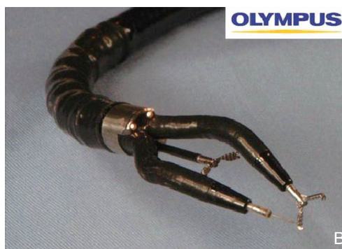
A: 工作臂; B: 末端操作器械
