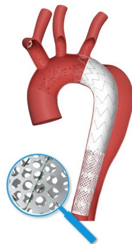
图2 Talos支架近端为主动脉覆膜支架全覆膜段,远端为打孔设计段(Talos支架示意图由心脉医疗提供)
