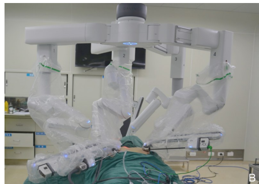
图1 UABA入路 A: Trocar置入后; B: Da Vinci Xi ® 机械臂与Trocar相连接后,插入专用操作器械
